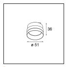
**10222430** Reflector 51 Medium WD **10222530** Reflector 51 Flood WD
